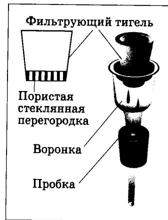
Рис. 7. Фильтр с пористой стеклянной перегородкой
