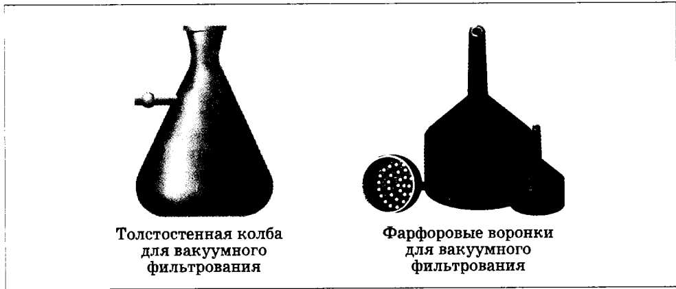
Рис. 25. Аппаратура для вакуумного фильтрования
